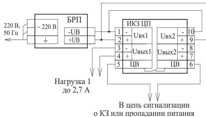
Схема подключения одного канала нагрузки и одного источника питания.
